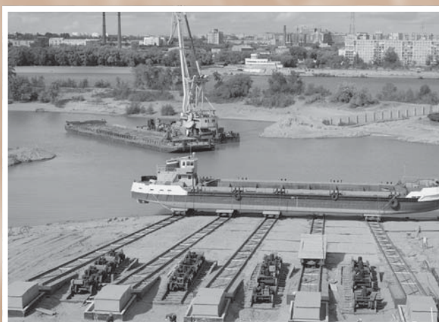
Подъем судна на судоподъемное сооружение – слип.
